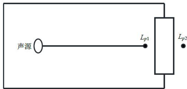
图 4-2 室内声源等效为室外声源图例
