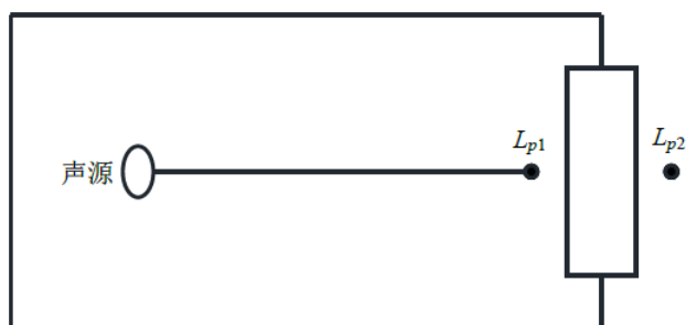
图 4-2 室内声源等效为室外声源图例
