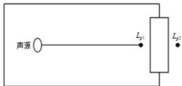
图 4-1 室内声源等效为室外声源图例
